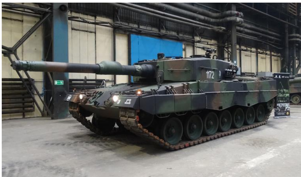
Rys 5 Czołg Leopard 2A4 – zgodnie z podpisaną umową na początku roku 2016, Zakłady Mechaniczne Bumar-Łąbędy, wraz z firmami współrealizującymi kontrakt, do roku 2020 wykonana modernizacja 128 egzemplarzy do standardu Leopard 2PL
